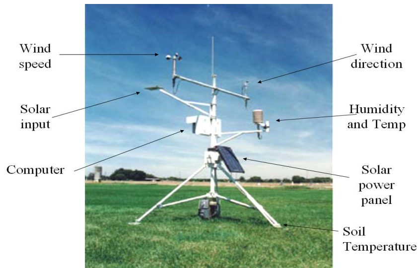
Estación meteorológica CIMIS
